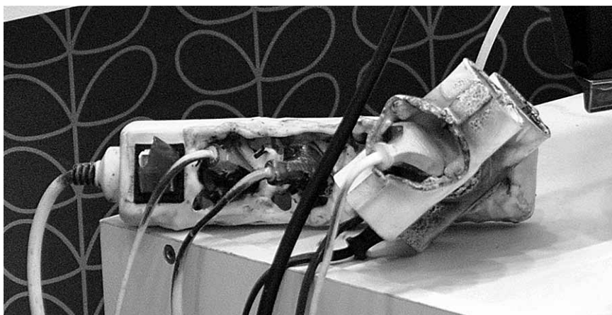
Ülepingest sulanud pistikud ja pikendusjuhe
